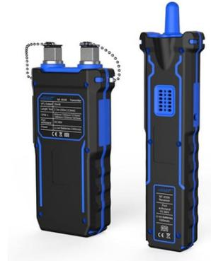
Merac optičkih vlakana – proverava greške u vlaknima emitujući crvene lasere i testira optičku snagu i vrednost slabljenja svetlosti.
